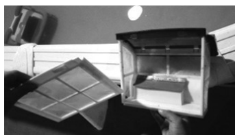
5. Trek het filterpaneel er verticaal uit
