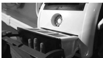
7. Työnnä suodatinkotelo takaisin allasrobottiin uraa pitkin
