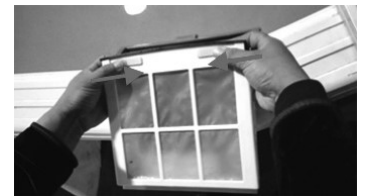
3. Työnnä keskeemmälle, jotta suodatinkotelo aukeaa
